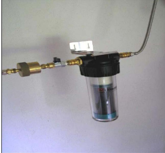
**Bild oben: HTKC mit Carbonitfiltergehäuse**
